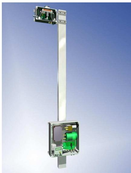
Le Fast Ozone analyseur se compose d'une sonde de mesure et d'une centrale d'acquisition. La sonde est constituée d'un boîtier étanche IP67 dans lequel est montée la cellule de mesure et son électronique d'acquisition, ainsi que les éléments nécessaires au prélèvement de l'échantillon (pompe, vanne, débitmètre, filtres...)
