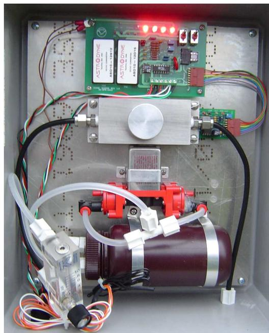
Figure 2 : analyseur utilisé pour les mesures de dépôt d'ozone au cours des projets *BIOPOLLATM* et *GESBiO3*
