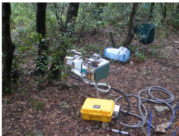
Photo. 1. Mesure de la respiration du sol par chambre automatique et échantillonnage par chambre portable
