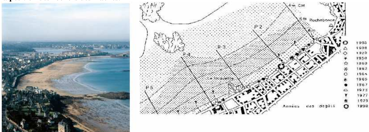
Figure 21 : Forme de la plage [GLAD] vue depuis Rochebonne vers la ville intra-muros (la flèche double indique le tombolo derrière le roc aux dogues) et position des dégâts relevés sur la digue[Bonnot et al., 1994].
