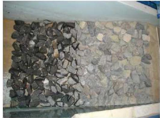
Figure 27 : Perré après mise en place d'une (à gauche) ou deux (à droite) couches d'engrèvements de calibre 4-6 T.
