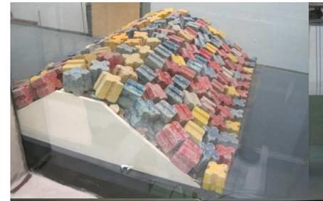
Par rapport au cas précédent la plus grande hauteur de la digue détachée induit une transmission moindre de l'agitation.
