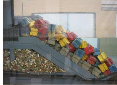
Comme les franchissements sont plus importants pour les périodes les plus grandes il est préférable de retenir la solution de la troisième couche sur la carapace plutôt que la digue détachée. A noter, que d'un point de vue économique, la solution d'une troisième couche sur la digue principale est sans doute plus intéressante que la digue détachée renforcée par une carapace monocouche en BCR car cette dernière nécessite un noyau.
