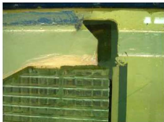
Figure 25 : Perré après mise en place du parapet de hauteur 1.5 m avec un béquet à 45° sur les 0.6 m supérieurs.
