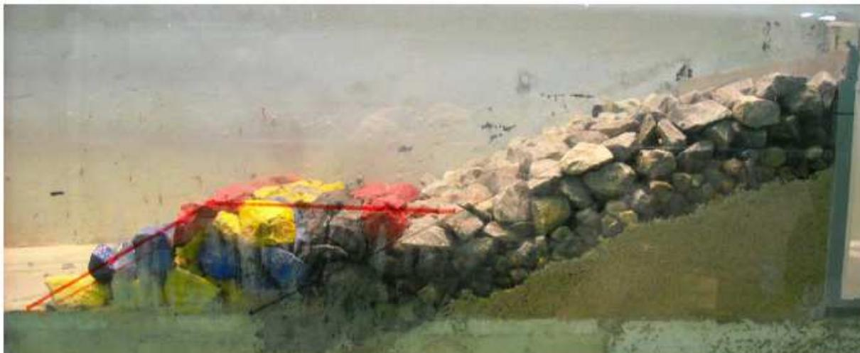
Figure 36 : Schéma et photo de l'ouvrage renforcé avec berme et parapet de 1 m.
