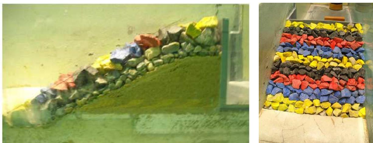
Figure 31 : Photographies du Canal 12 et du modèle réduit sans renforcement.
