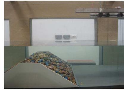
La Figure 17 présente la disposition de la digue détachée dans le canal ; ainsi que la disposition des trois ensembles de quatre sondes permettant de mesurer les climats de houle devant le batteur, devant la digue détachée et entre les deux ouvrages.
