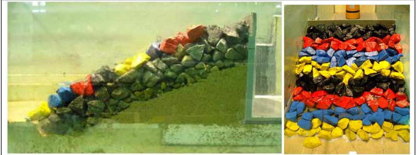
Figure 34 : Schéma et photos de l'ouvrage renforcé avec une 3<sup>ème</sup> couche de blocs de 5-6 t et parapet de 2 m.
