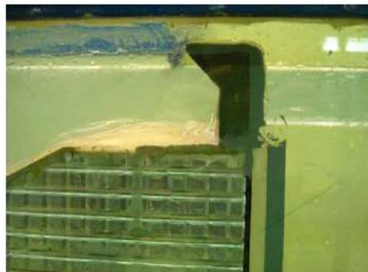
Figure 64 : Photographies du perré après mise en place du parapet de hauteur 1.5 m avec un béquet à 45° sur les 0.6 m supérieurs.
