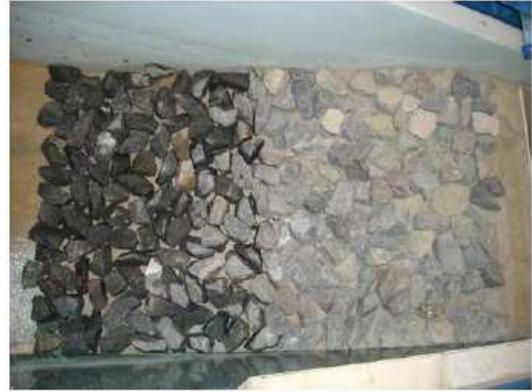
Figure 66 : Photographies du perré après mise en place d'une (à gauche) ou deux (à droite) couches d'enrochements de calibre 4-6 T.
