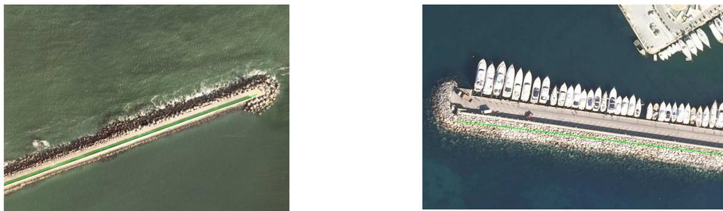
Figure 2 : Exemples de digues à talus : à gauche en blocs béton, à droite en enrochement naturel. (source : Google Earth).
