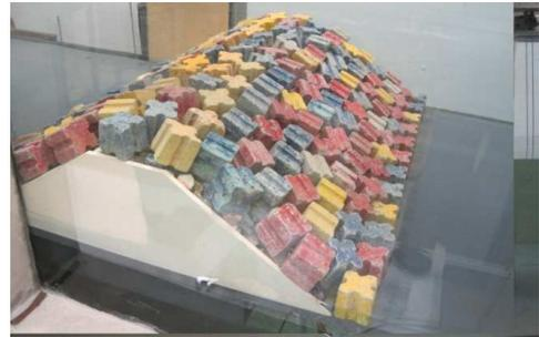
Par rapport au cas précédent la plus grande hauteur de la digue détachée induit une transmission moindre de l'agitation comme le montre la Figure 42 représentant les évolutions du coefficient de transmission  $K_t$  de la digue détachée.
