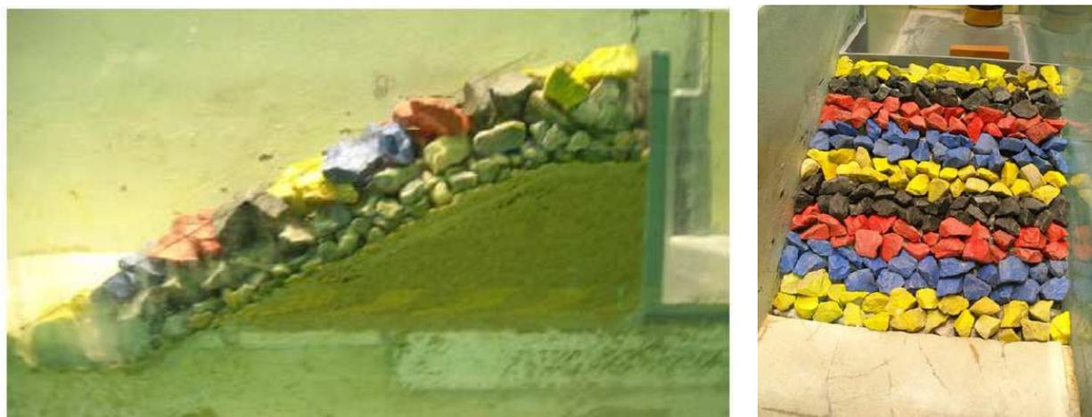
Figure 70 : Photographies du Canal 12 et du modèle réduit sans renforcement.
