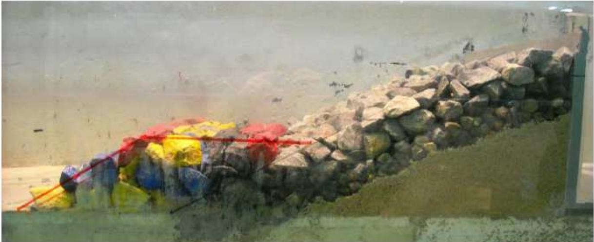
Figure 83 : Schéma et photo de l'ouvrage renforcé avec une berme et avec un parapet de 1 m. Les parties en vert dans le schéma représentent les modifications apportées à l'ouvrage original. Les blocs colorés dans la photo représentent les enrochements qui ont été ajoutés à l'ouvrage original pour réaliser le renforcement.
