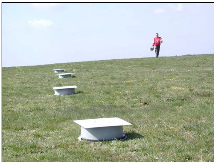
Figure 6 - Chambres de mesure des émissions de N 2 O à Laqueuille en 2002
