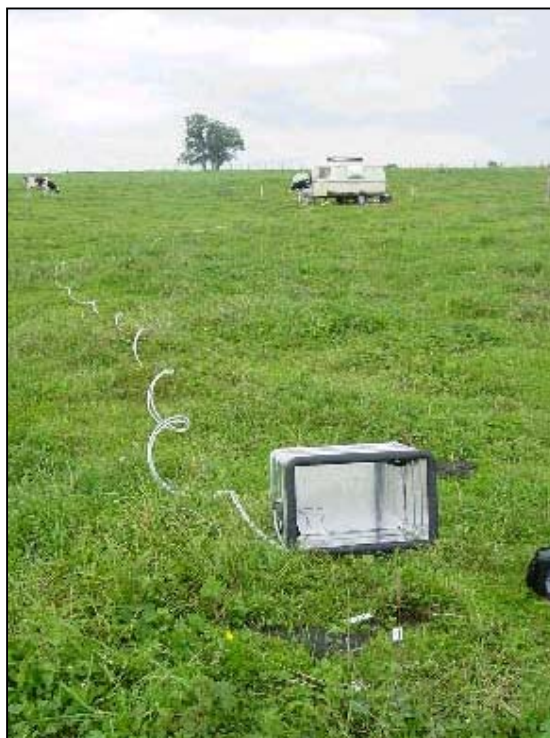
Figure 7 - Caravane abritant le système TDL et chambre de mesure utilisée pour étudier les variations spatiales des émissions de N_2O lors de la campagne de mesure à Laqueuille en Septembre 2002
