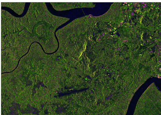
FIGURE 4.12 – A gauche, une image en fausses couleurs de la région de Cayenne (Guyane) avec \sigma_{VV}^0 dans le canal rouge, \sigma_{VH}^0 dans le canal vert et \frac{\sigma_{VV}^0}{\sigma_{VH}^0} dans le canal bleu prise le 19/01/2016 (IW 5 \times 20 m). A droite une image GoogleEarth de la même région.
